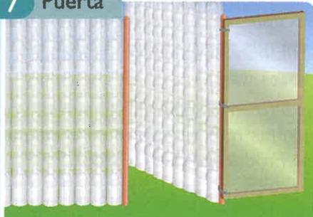
Utilicen los listones de madera y el polietileno grueso para construir la puerta. Al finalizar la construcción, asegúrenla con el alambre a la estructura.
