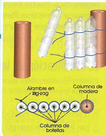
Para la construcción de las columnas, la base debe comenzar con una botella completa (sin cortes), que se colocará en la zanja. Corten las siguientes botellas por la mitad y consideren la parte que incluya su base para encajarlas una sobre otra.
